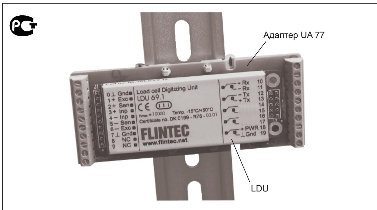
Быстродействующие прецизионные тензопреобразователи серии LDU 69.1/78.1 обладают высокоточным 20-разрядным АЦП, что позволяет работать как со статическими, так и с динамическими сило/весоизмерительными системами.
